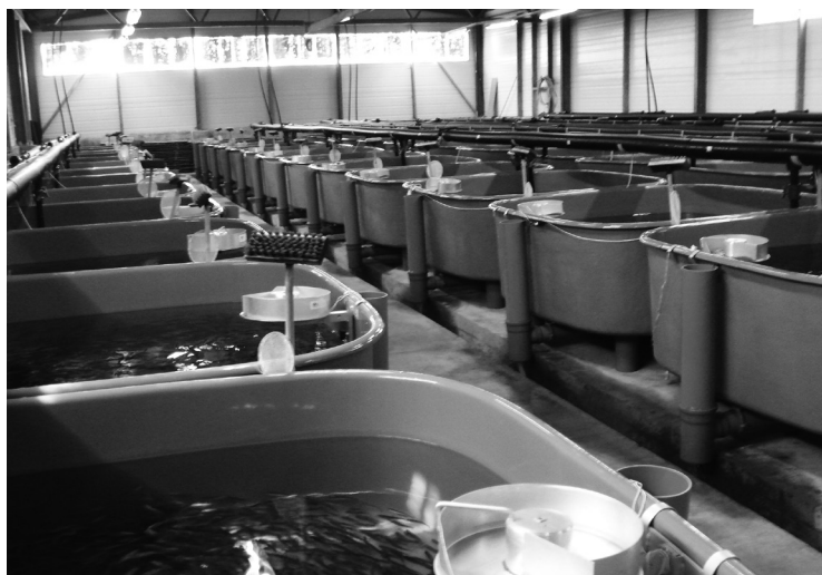
Рис. 3.2.11. Пластиковые бассейны с круговым током воды, применяемые для подращивания молоди тихоокеанских лососей
