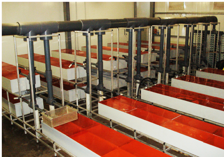
Рис. 3.2.8. Инкубационный цех, оборудованный аппаратами Аткинса
